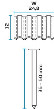
**Anwendungsgebiete:** Alle Anwendungen bei denen extrem bündiger Eintrieb der Nägel erforderlich ist: Feuerschutzwände, Rigipswände und Fassaden
