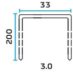
**Anwendungsgebiete:** *Isolierung im Holzrahmenbau mit Holzfaserplatten <160 mm*
