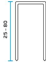
**Anwendungsgebiete:** Speziell für den Einsatz in Multifunktionsbrücken des Fertighausbaus konstruiert
