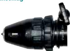
Einstellbarer Tiefenanschlag für Schlagschrauber mit 1/4"-Werkzeugaufnahme. Inkl. magnetischem Bithalter mit 60 mm Länge und einem PH2-Bit. Passend für alle Makita-Schlagschrauber mit Ø 28,5 mm-Flansch.
