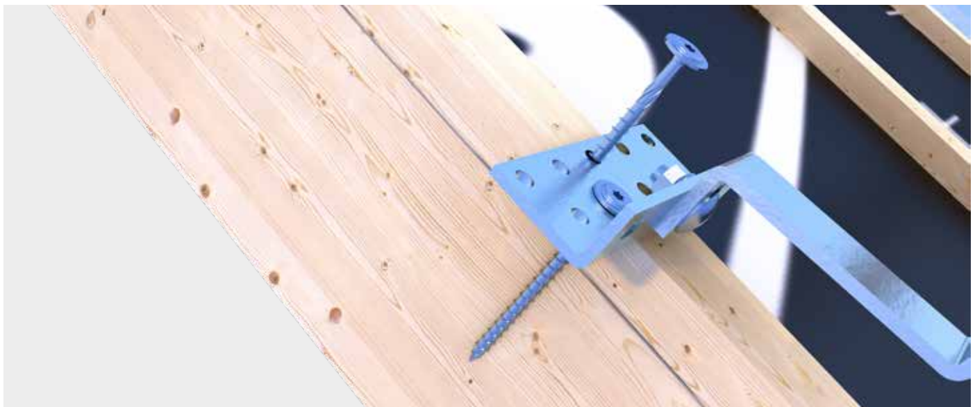
Die Paneltwistec Tellerkopfschraube wird zur Befestigung der Dachhaken genutzt und durch die Konterlatte in den Sparren geschraubt.
