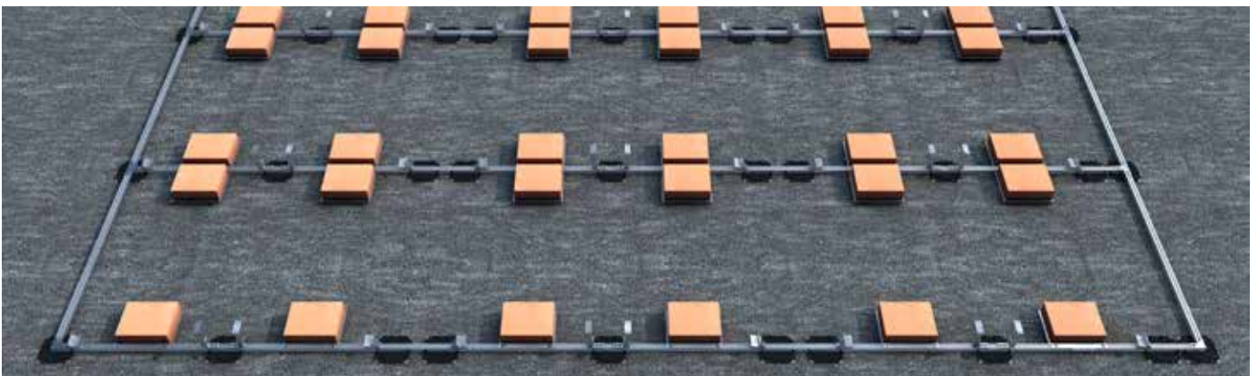
SCHRITT 3: Die verschiedenen Gelenke werden auf die Profile geschraubt.
