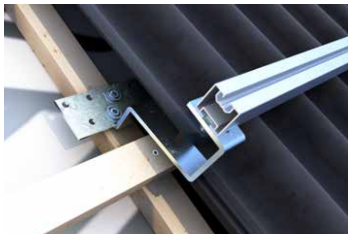
Montageprofil Steildach 40 x 40/40 x 80 mittels Hammerkopfschraube und Sperrzahnmutter am Dachhaken befestigt.
